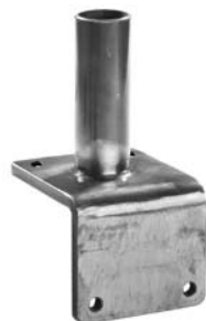
Art. 65-16-09 Tubo Ø 35 x 2 mm □ 90 x 90 mm Spessore 8 mm Fori Ø 8,5 mm Kg 1,040
